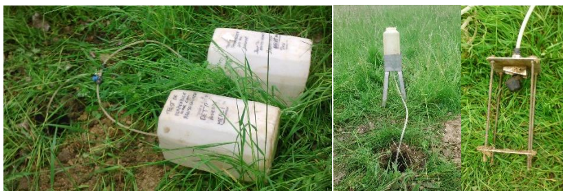
Figure 13 Saturation du sol (à gauche) et Test de Porchet (à droite)
